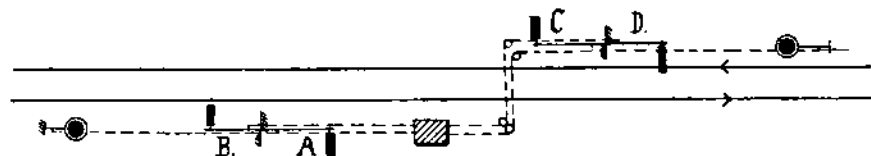
Haltepunkt mit Einfahrts-, Ausfahrts- und Vorsignalen.
