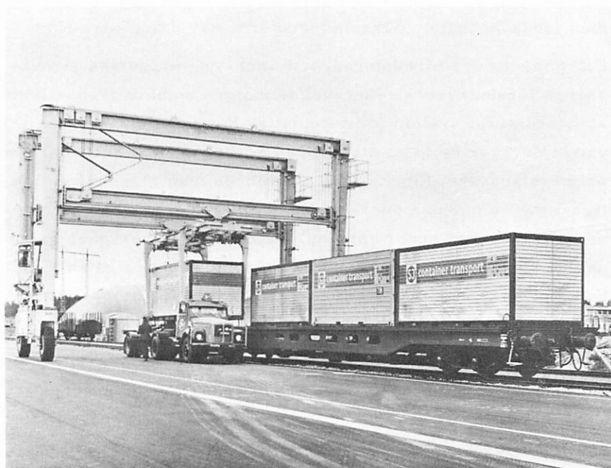
Med den nya 30-tonskranen lyfts containern snabbt från bil till järnvägsvagn
