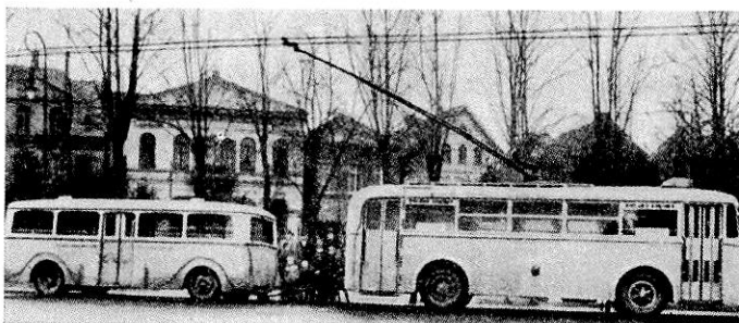
Bild 9. Trådbuss med släpvagn för Oldenburgs förortslinjer.
