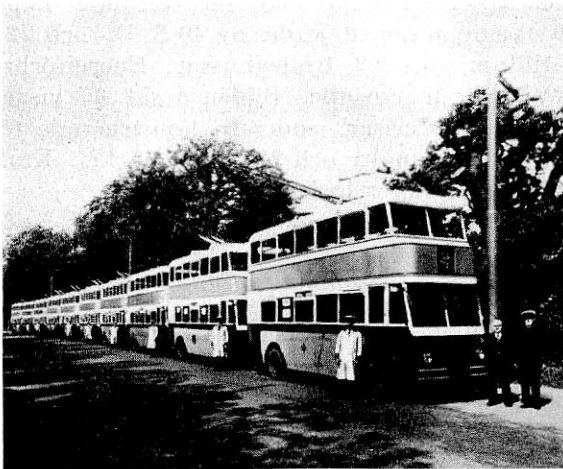
Ipswich. Trolleybuss D. D. 48 sittplatser, 20 å undre däcket, 28 å övre, 80 hk. Fabrikat Ransomes.
