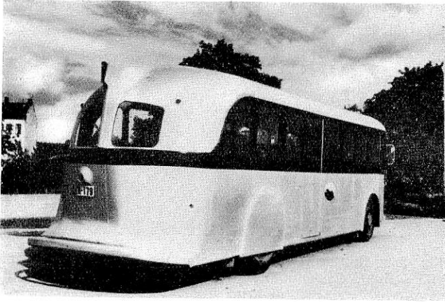
Fig. 36. Al-buss, typ SV-800, sedd bakifrån med avgasning upptill och skidställ nedtill.
