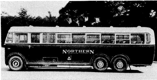
Fig. 11. N. G. T. buss med motorn placerad vid sidan av ramen. Vagnen rymmer 45 sittande passagerarna.
