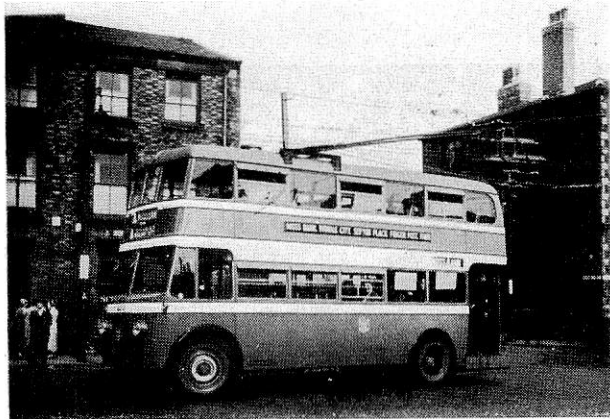
Fig. 22. St. Helens. Trolleybuss för 50 sittande pers. Enmotorig drift 80 hk. Motorvikt pr hk. 5,0 kg.
