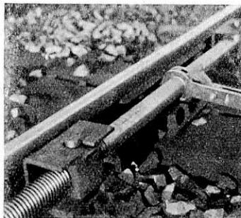
Bild 14. Schienenrücken Maróti.
