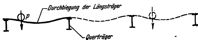
Abb. 1. Die elastischen Längsträger können die Ursache von Aufschaukelungen der Brücke in der Grundschiwingung sein.
