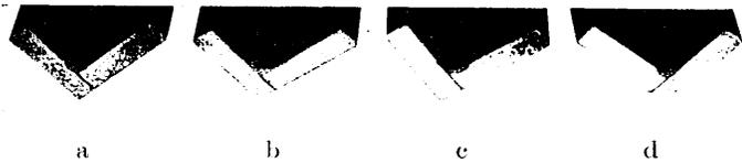
a Waagrecht geschweißt (ein Schenkel lag waagrecht, der andere Schenkel stand senkrecht). — b Waagrecht geschweißt (die Winkelhalbierende stand senkrecht). — c Senkrecht geschweißt (unbrauchbar). — d Überkopf geschweißt (unbrauchbar).
