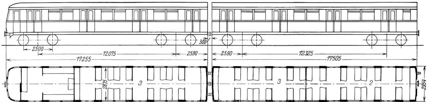
Abb. 16. Viertelzug der Berliner Stadtbahn für 110 km/h (Bauart 1935).
