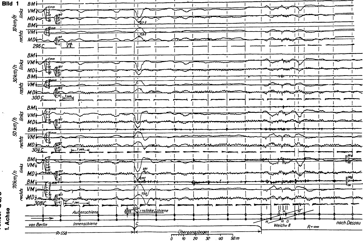
Fahrten aus einem Rechtskreisbogen durch einen Übergangsbogen mit Absenkung des linken Schienenstranges um 0,033m (Rampenneigung 1:75)
