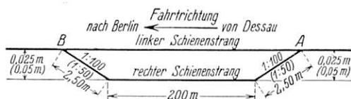
Abb. 34. Rampen im rechten Schienenstrang des geraden Gleises.
