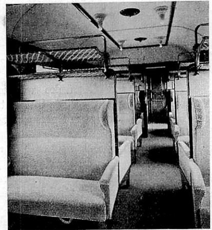
Abb. 21. Inneneinrichtung der vierachsigen Durchgangspersonenzugwagen 2. Klasse.
