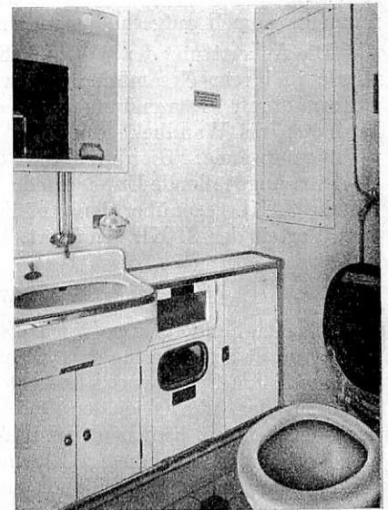
Abb. 13. Abort eines Ganzstahl-D-Zugwagens.
