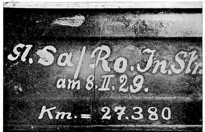
Abb. 13. Der Bruch beginnt vom Fuße aus; die Lauffläche ist noch unbeschädigt.
