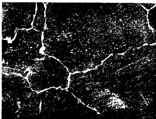
Abb. 10. Überhitztes Radreifenmaterial, starke Kornvergrößerung, 165fach vergrößert.
