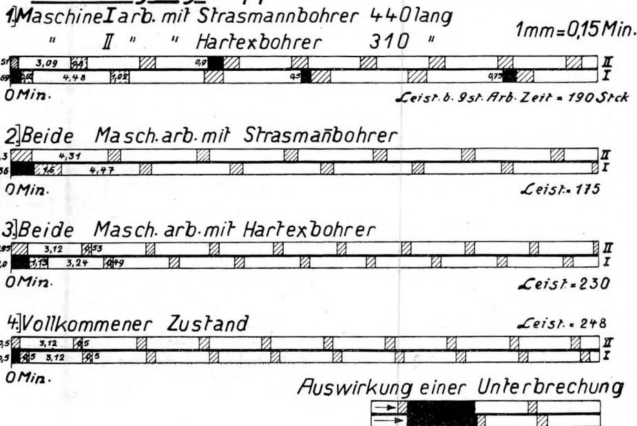
Abb. 4. Bedienung von 2 Maschinen durch 1 Arbeiter.
