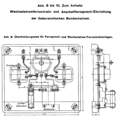
Abb. 8 bis 10. Zum Aufsatz: Wechselstromfernsehreib- und Anschaltzetz-Einrichtung der österreichischen Bundesbahnen.
