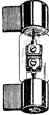
mindert, daß die eisernen Teile der Befestigung der Elektroden aus Kohle so verlängert sind, daß sie bis dicht an den Glaskörper reichen (Textabb. 1). Außerhalb des Glaskörpers sind an die mit Platin überzogenen Stahldrähte Kupferdrähte zur Verbindung mit den Messingkappen des Blitzableiters angeschweißt.
