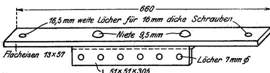
Gleisen. Er besteht aus einem 305 mm langen Winkelleisen  $51 \times 51$  mm, das an ein 660 mm langes Flacheisen von  $13 \times 57$  mm genietet ist. In das Flacheisen wird je ein 16,5 mm weites Loch etwa 7,5 cm von beiden Enden gebohrt, so daß es mit 16 mm dicken Schrauben an den Schwellen befestigt werden kann. In das Winkelleisen werden 7 mm weite Löcher in ungefähr 5 cm Teilung gebohrt, durch die die Stelldrähte laufen. Die Abmessungen werden nach den örtlichen Bedingungen abgeändert. B—s.
