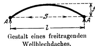
Gestalt eines freitragenden Wellblechdaches.
