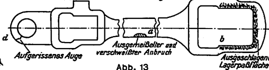
Abb. 5. Ausbessern von Brüchen, Auftragen von Paßflächen, Anschweißen von Stücken an Trieb-, Kuppel- und Steuerstangen.
