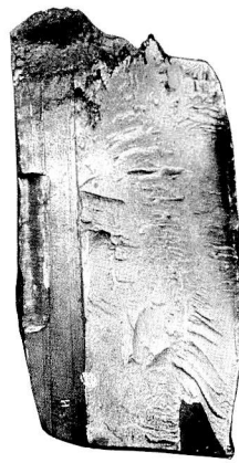
Abb. 5. Großgefüge der Schienenproben aus vier Kopfschienen.
