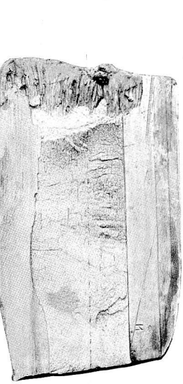
Abb. 1 bis 4. Längsschnitte der aus dem Kopfende des Blockes stammenden vorgewalzten und abgeschnittenen Blockenden.
