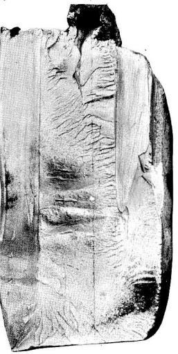
Abb. 1 bis 4. Längsschnitte der aus dem Kopfende des Blockes stammenden vorgewalzten und abgeschnittenen Blockenden.
