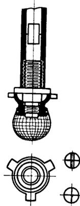
Abb. 14. Verpackung des Glühkörpers. Maßstab 2:3.
