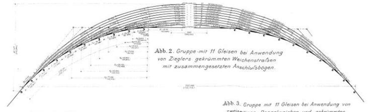
Abb. 2. Gruppe mit 11 Gleisen bei Anwendung von Ziegler's gekrümmten Weichenstraßen mit zusammengesetzten Anschlussbögen.
