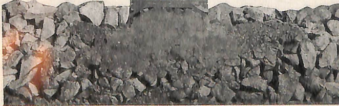
Abb. 9. Querschnitt nach der 17. Stopfung. Gesamte Senkung 335 mm, 1079 Stopfschläge, 1516700 Belastungen.
