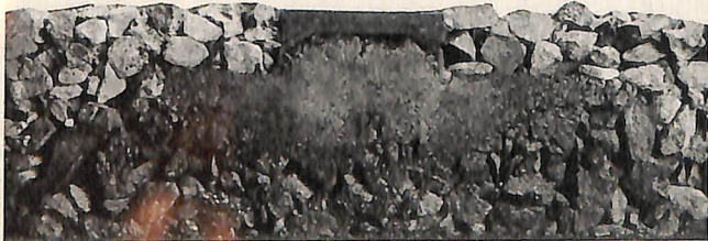
Abb. 8. Querschnitt nach der 14. Stopfung. Gesamte Senkung 279 mm, 899 Stopfschläge, 802545 Belastungen.
