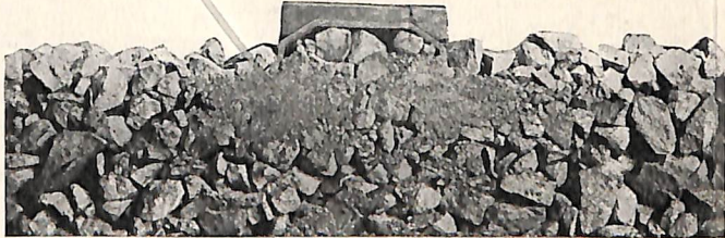
Abb. 6. Querschnitt nach der 6. Stopfung. Gesamte Senkung 120 mm, 419 Stopfschläge, 182088 Belastungen.
