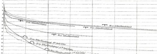
Abb. 27. Vergleichende Zusammenstellung der 3 Schwellenabstände beider Schwellenarten
