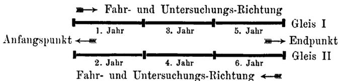
Bei zwei- oder mehrgleisigen Linien mit einjähriger Wiederkehrdauer wird zuerst Gleis I auf der für das betreffende Jahr vorgeschriebenen Strecke vollständig untersucht; danach Gleis II u. s. w.
