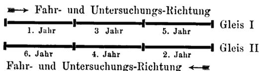
Dadurch erhalte man aber örtlich gleich gelegene Linientheile der beiden Gleise, deren innerer Werth verschiedener ist, als bei der Anordnung von Fig. 45, welche daher den Vorzug verdient.
