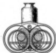
Fig 6 Querschnitt durch die Feuerbüchse.
