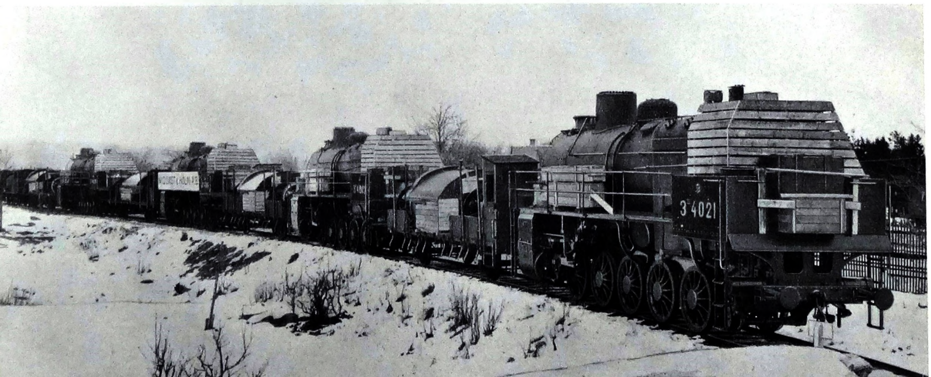
Transporte de locomotoras sobre ruedas especiales para la Unión Soviética
