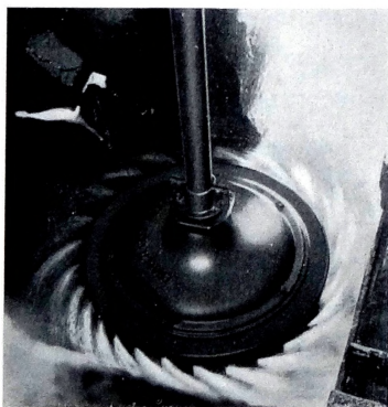
Una de las primeras turbinas de agua entregada en 1849, todavía en servicio.
