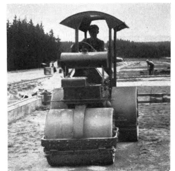
Fig. 3577. Diesel-Trehjulsvält. Vikt ca 6,7 ton.
