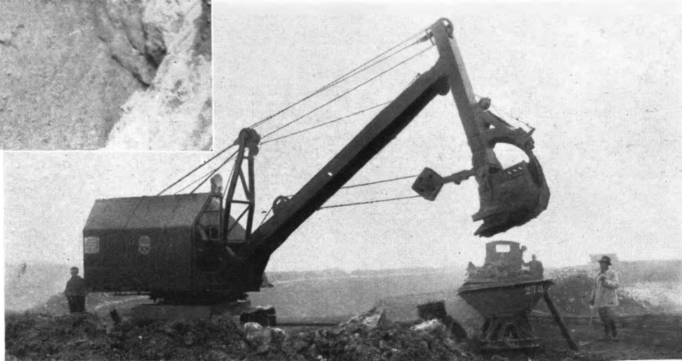
Fig. 19065 Typ L 3. Djupgrovare med tippar skopa för ar- beten i hård mark.
