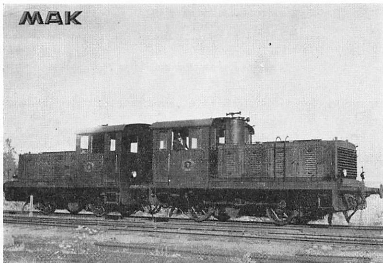
Fig. 7. Dubbellokomotor för N. B. f., 480 hkr.
