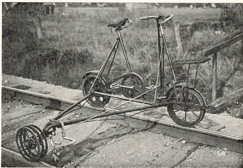
Fig. 1. Apparat för spårviddskontroll monterad på cykeldressin.
