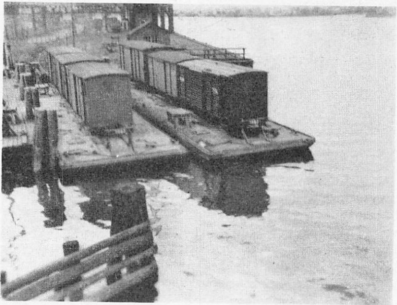
Fig. 30. Härå visas 2 st. i pråmläget införda pråmar, båda lastade med 3 st. vagnar.
